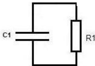
À  $t = 0$ , le condensateur se décharge dans la résistance.
