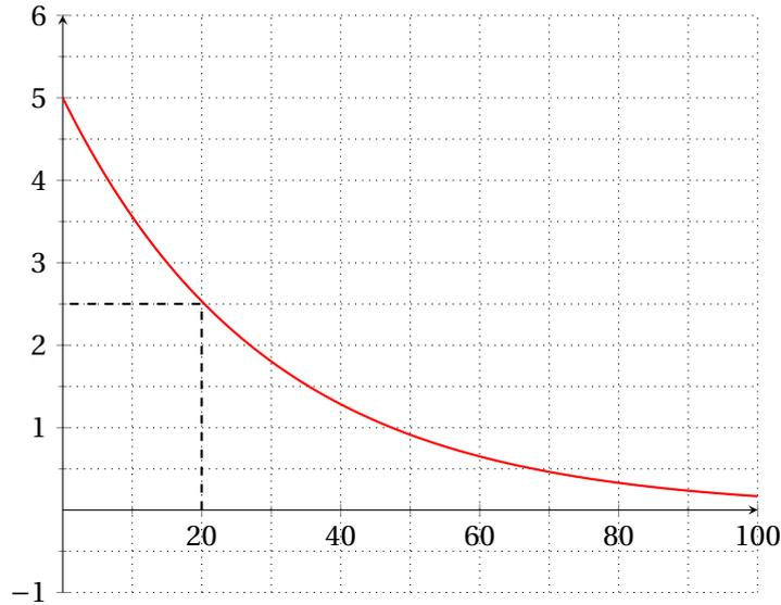
On voit que c'est pour  $x = 20$ , soit **20 km de fibre** que la puissance du signal est divisée par 2.
